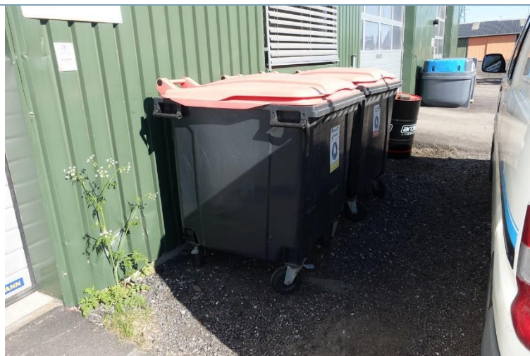
Bilde 15: Konteinere med brennbart avfall må plasseres min. 8 m fra fasade med vinduer.
