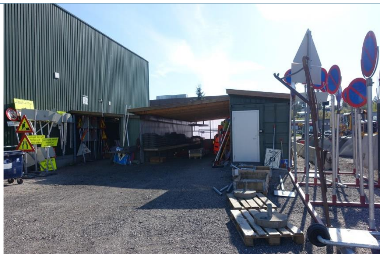
Bilde 14: Utendørs lagring av ubrennbare materialer delvis under tak på utsiden av bygningen. 48 m 2 av lageret, mot vegglivet har 3 vegger og inngår i bygningens bruttoareal.
